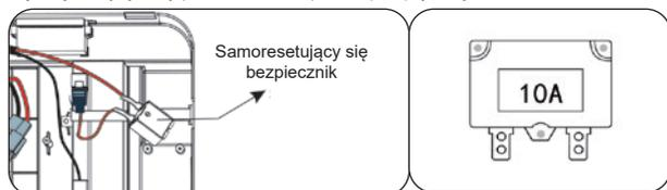
Model ten jest wyposażony w ochronnik przeciwprzepięciowy. Jeśli model jest przeciążony, urządzenie przeciwprzepięciowe automatycznie wyłącza się i resetuje w ciągu 5 do 10 sekund. Bezpiecznik znajduje się pod siedzeniem.
