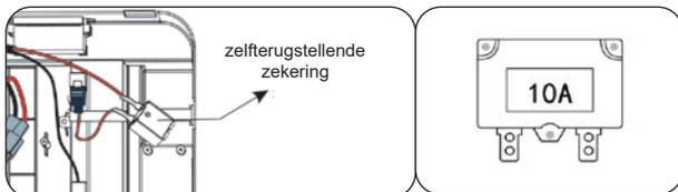
Het voertuig is uitgerust met een zelfterugstellende zekering. Wanneer de auto overbelast is of verkeerd wordt gebruikt wordt gebruikt, zal de zelfterugstellende zekering gedurende 5 - 10 seconden uitschakelen voordat deze weer operationeel. De zelfterugstellende zekering bevindt zich onder de stoel.
