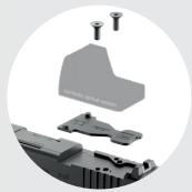
Nach dem Einsetzen der Adapterplatte können die Optiken direkt in den Verschluss geschraubt werden. Dies erhöht die Haltbarkeit und Stabilität.
